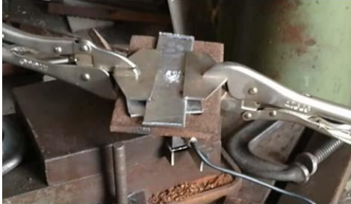
Fig. 4 FSSW specimen fixation
